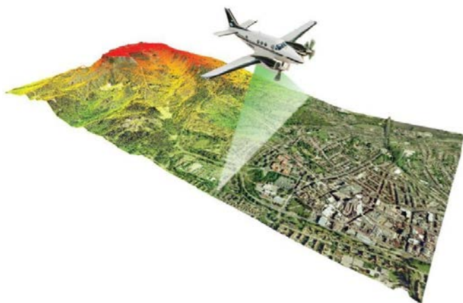
Рис. 8.15. Схематичне зображення процесу дистанційного знімання за допомогою лідарів
