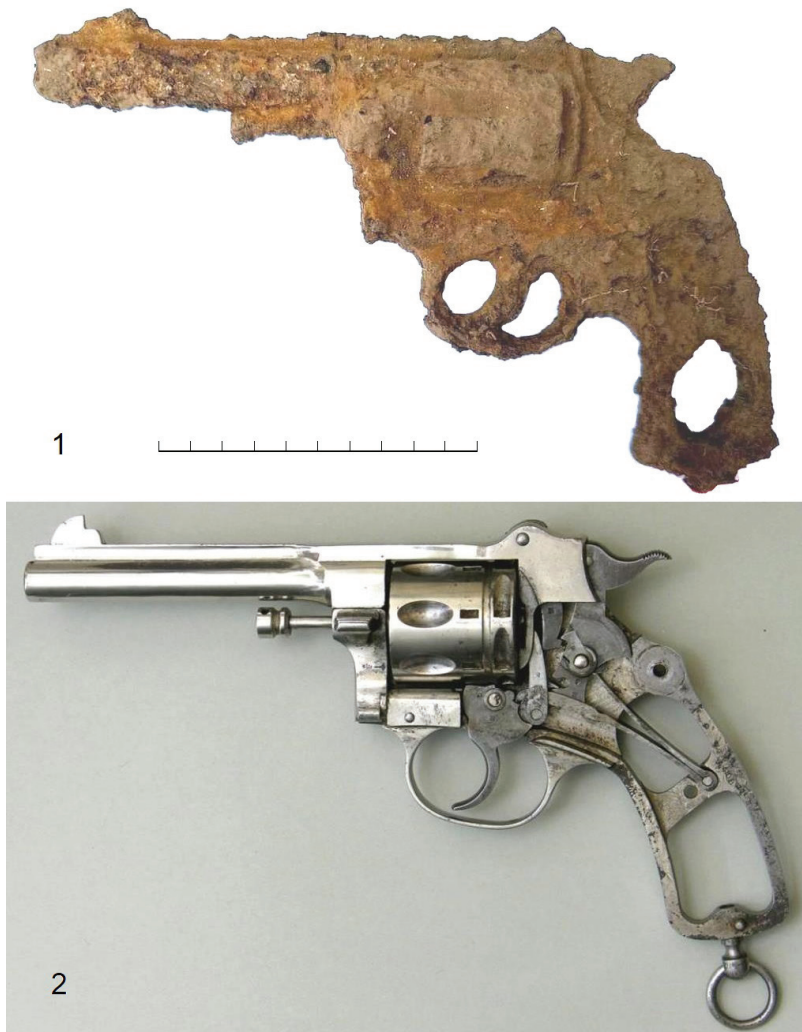
Рис. 1. Револьвер із парку в м. Чернівці (1) та механізм револьвера Піпера М1889 (2).
