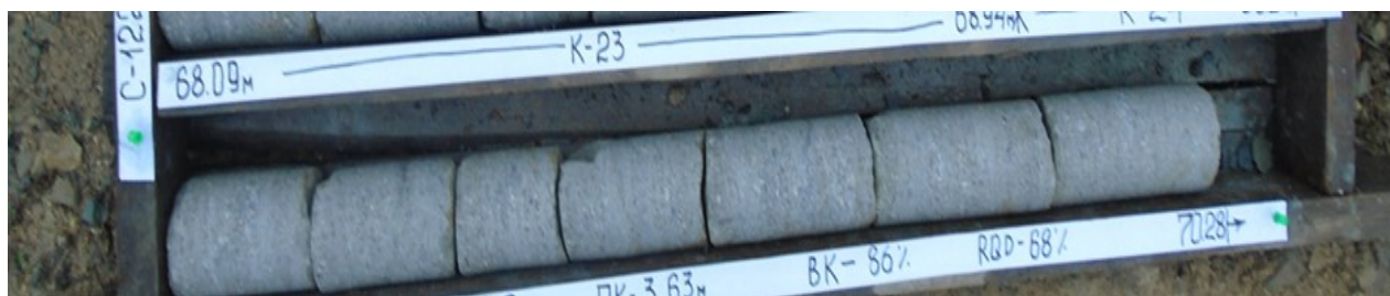
Рисунок 3.1 – Керн геологічного шару V_{2cs} (пісковики сокілецькі) (розроблено автором)
