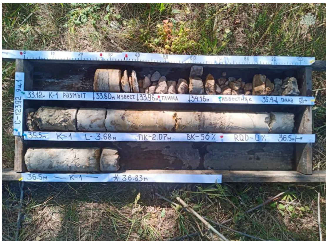
Рисунок 3.4 – Керн геологічного шару з глибини 35 – 37 м (прошарки бентонітових глин) (розроблено автором)
