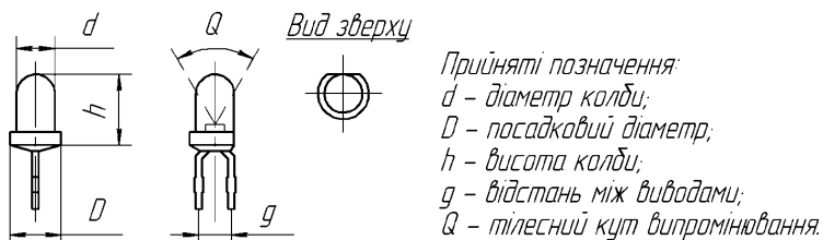
Рис. 1. Спрощене креслення світлодіода
