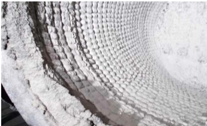
Рис. 1. Типовий знос робочої футеровки сталерозливного ковша
