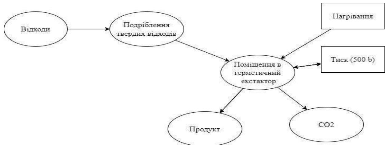
Рис. 1.7. Процес переробки сільськогосподарських відходів методом флюїдної екстракції
