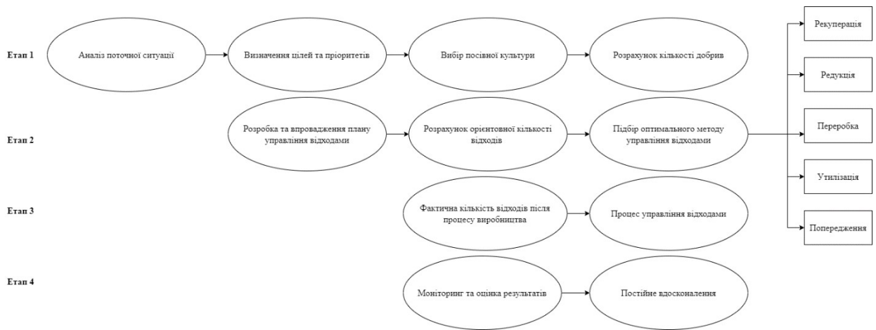
Рис. 38. Процес оптимального прийняття рішень в управлінні відходами
