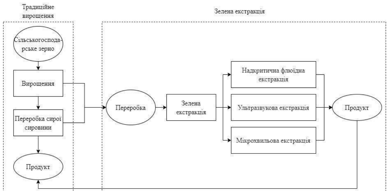
Рис. 1.6. Процес зеленої екстракції за типами переробки
