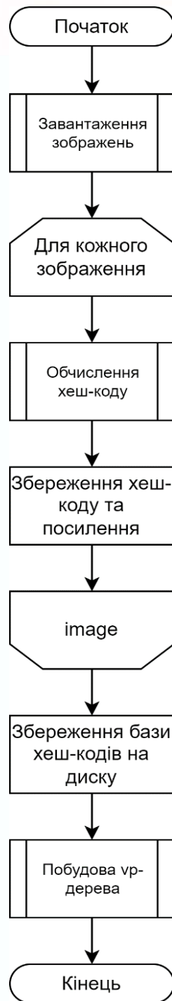
Рис. 2 Блок-схема етапу створення бази хеш-кодів зображення
