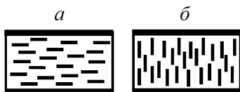
Рис. 15.5. Розташування молекул у рідкому кристалі: а – гомогенне; б – гомеотропне
