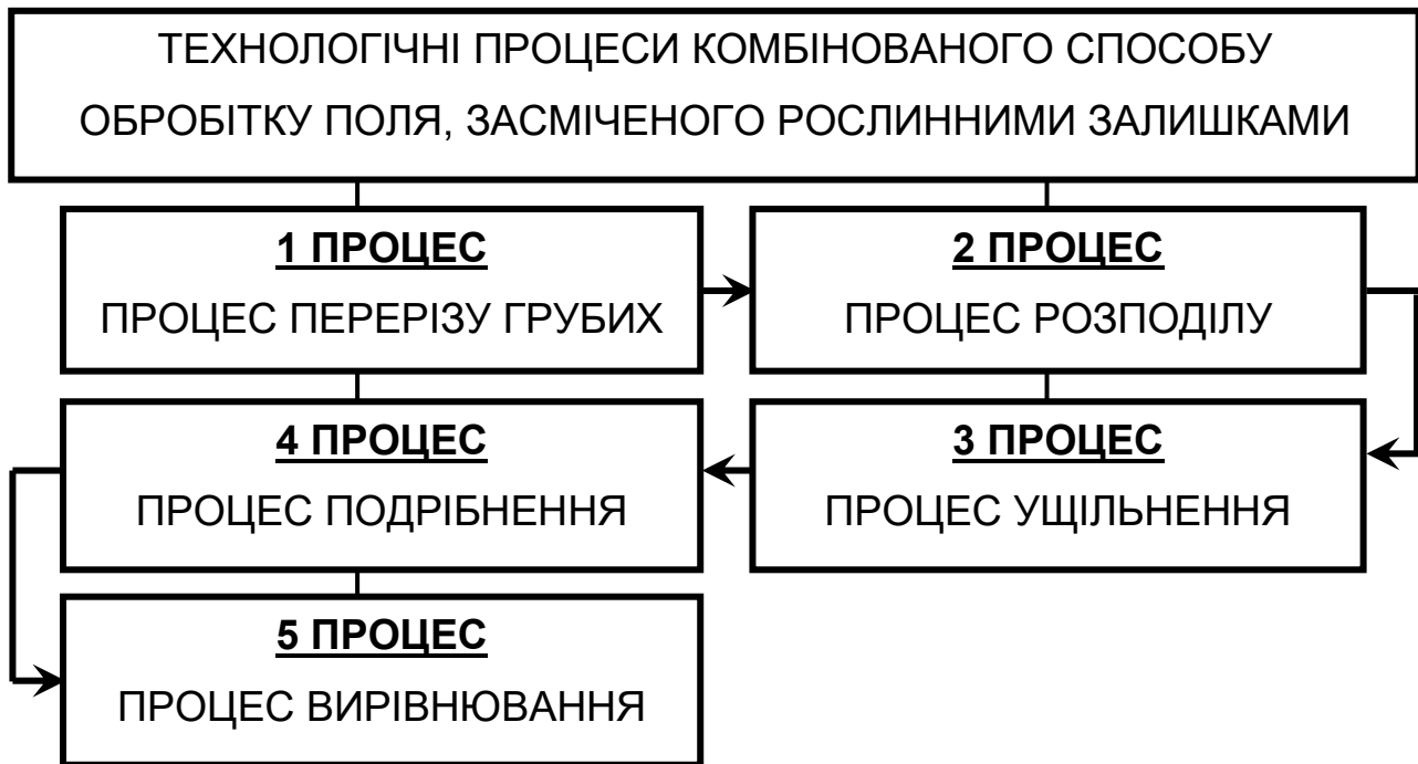
Рис. 1. Схема комбінованого способу обробітку поля, засміченого рослинними залишками кукурудзи
