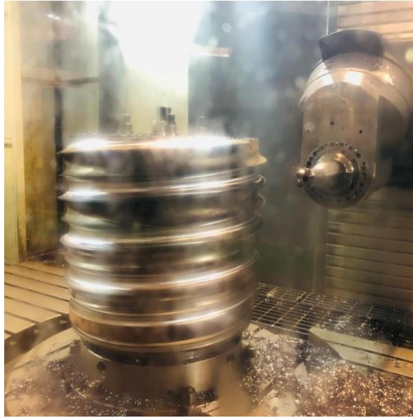
Рис.1. Загальний вигляд відновленого валка шаропрокатного стану
