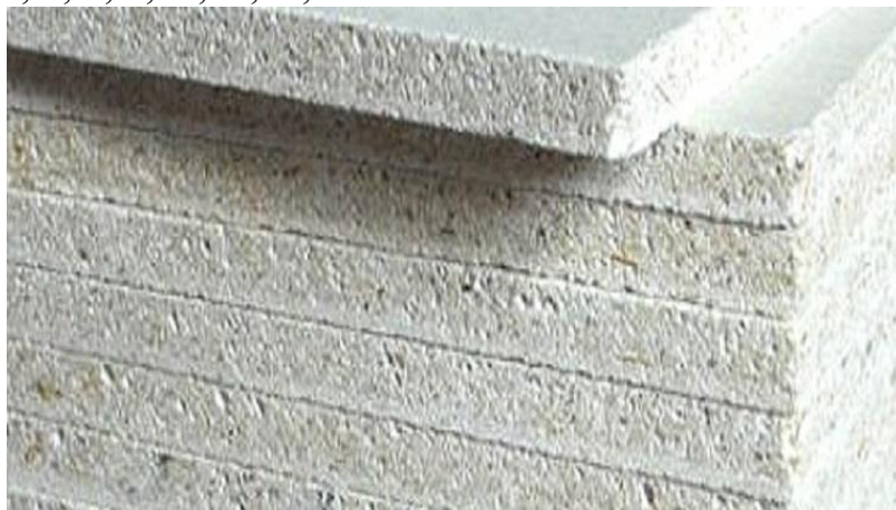
Рис. 3. Структура та текстура магnezитової плити.
