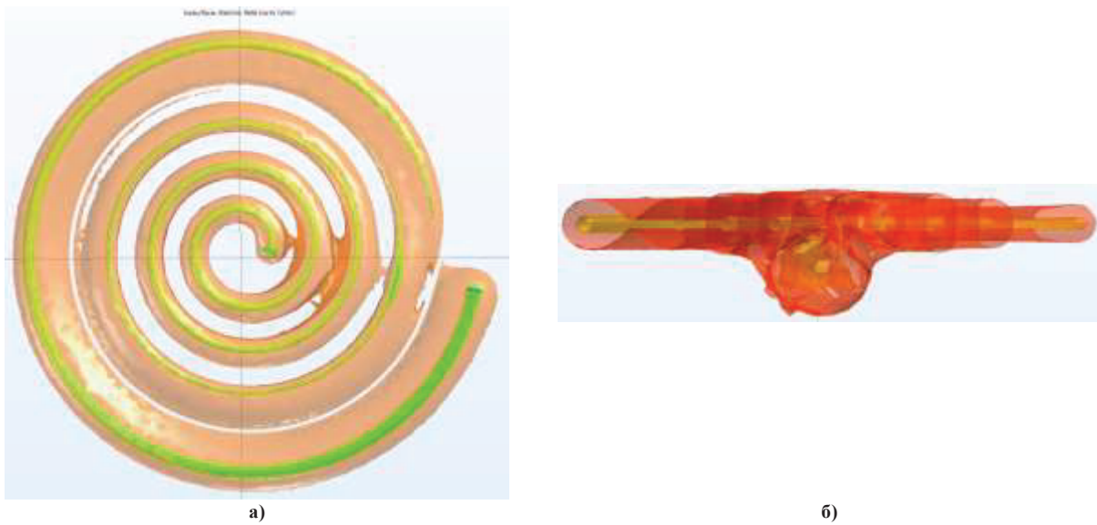
Рис. 4. Ізоповерхня електromагнітного поля досліджуваної моделі: а) вигляд зверху; б) вигляд збоку
