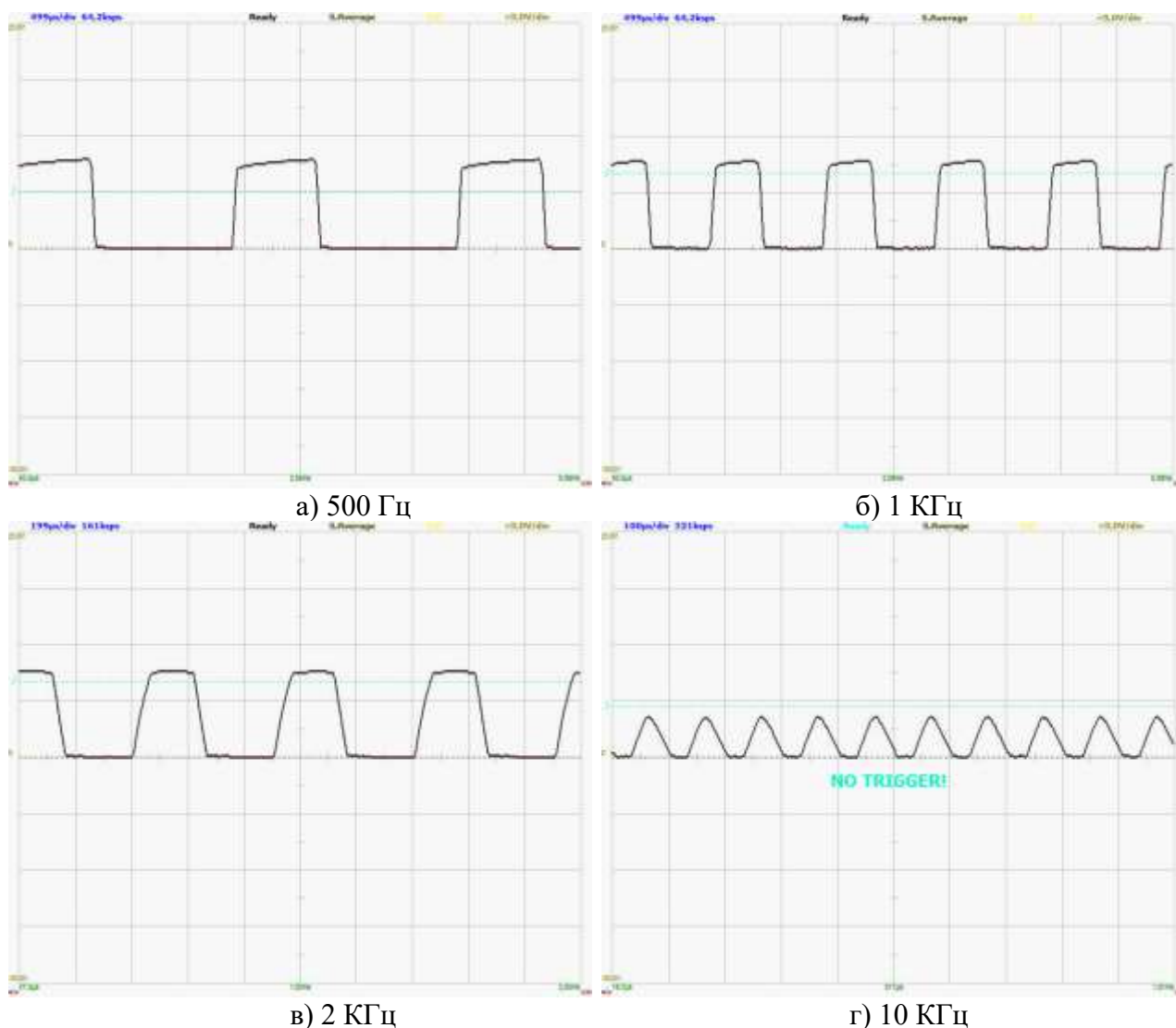
Рисунок 4. Осцилограми сигналів на виході приймача для частот
