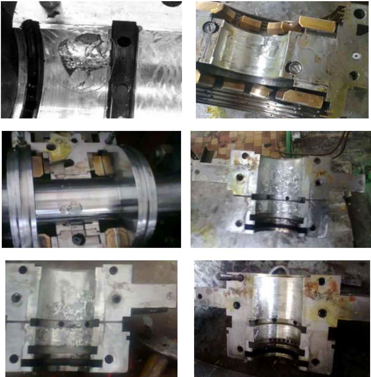
Рисунок 3. Загальний вигляд вкладиша опорного та опорно-упорного підшипника відцентрового нагнітача ГПА Павлоградського п/м Запорізького ЛВУМГ з виїмкою шматка бабіту.
