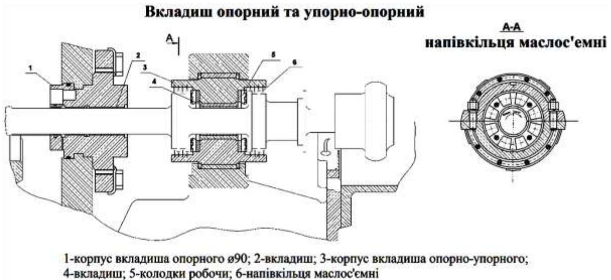
Рисунок 2. Вкладиш опорний и опорно-упорний.
