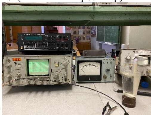
Рис. 1. Ультразвукова обробка закваски
