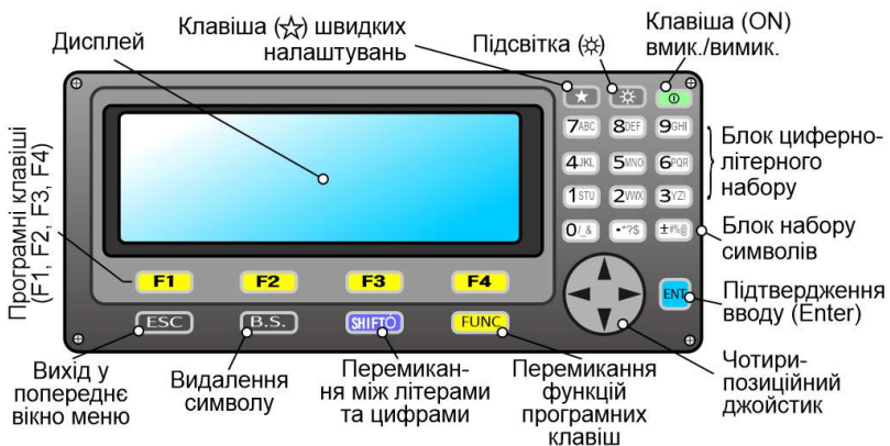
Рис. 1.5. Робоча панель електронного тахеометра Sokkia CX-55
