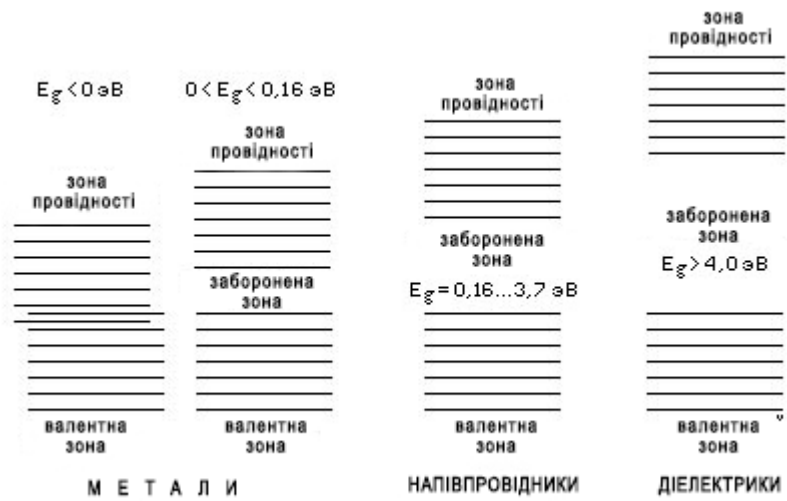
Рис. 1.2. Схема енергетичних зон для різних матеріалів
