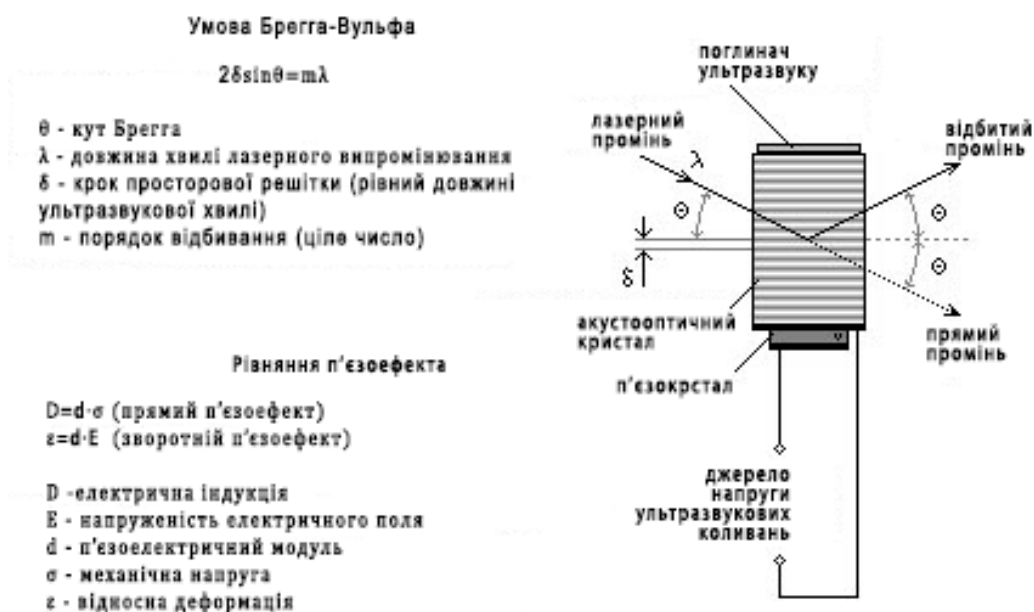
Рис. 5.5. Принцип дії акустооптичного дефлектора (модулятора)
