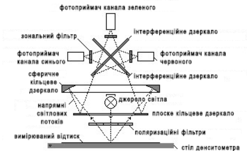
Рис. 12.2. Оптична схема головки денситометра
