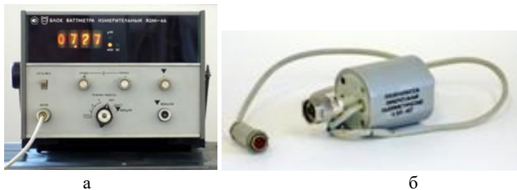
Рис. 2.1. Ватметр поглинаючої потужності МЗ-51: а) - блок ватметра вимірювальний Я2М-66, б) - перетворювач вимірювальний термоелектричний 4.681.467
