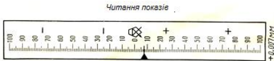
Рис. 4.12. Повне зображення шкали та зчитування показів: вимірювальні межі \pm 0,1 мм; ціна проділки 0,001 мм; відлік +0,007 мм
