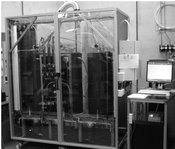
Рис. 3. Лабораторна установка Інституту для ферментативної метанації водню та діоксиду вуглецю під тиском
