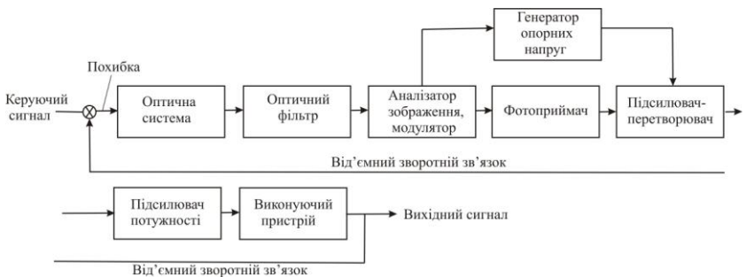
Рис. 4. Функціональна схема приймальної частини ОЕС відстежуючого типу
