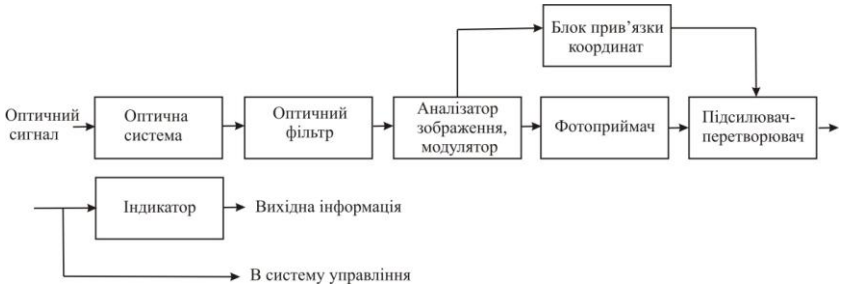
Рис. 3. Функціональна схема приймальної частини ОЕС вимірювального типу
