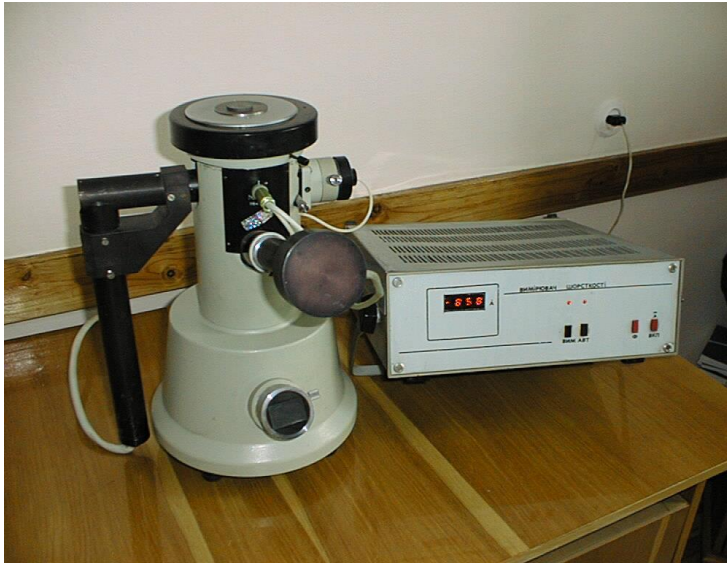
Рисунок 4.3.2. Фотографія макету приладу, що реалізує інтерференційний метод на рисунку 4.3.1.
