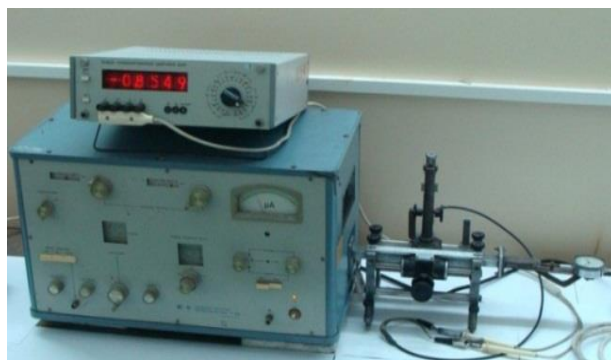
Рис. 1. Общий вид измерительного комплекса на базе волноводной измерительной линии (ИЛ) с зондом и передвижным плунжером с микрометрическим винтом
