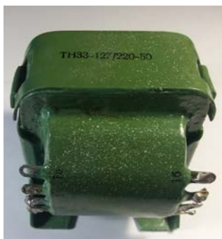
Рисунок 6.3.2 – Зовнішній вигляд трансформатора з напругою мережі 220 В або 127 В частоти 50 Гц. Трансформатор містить чотири вторинні обмотки
