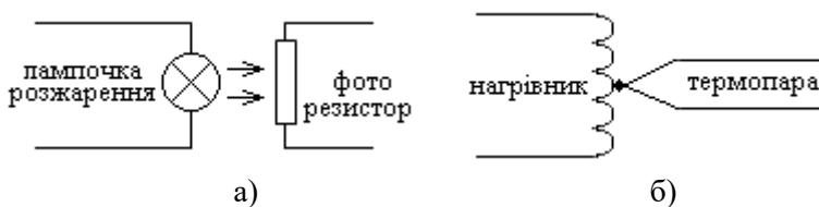
Рисунок 4.6.3 – Пристрої отримання сигналу, пропорційного до діючого значення перемінної напруги: а) оптопара (лампочка розжарення – фоторезистор); б) термохрест (нагрівник – термопара)
