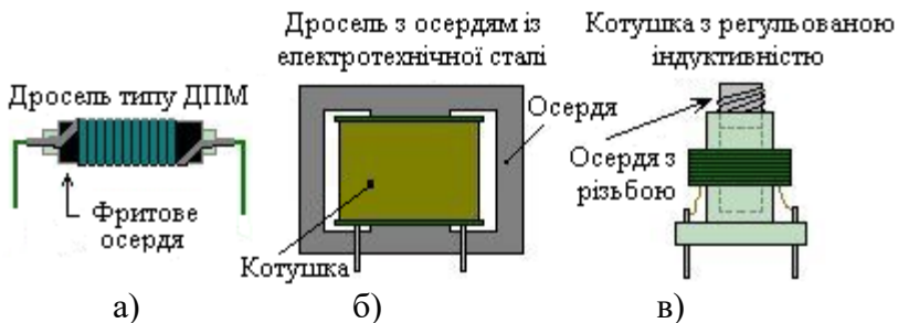
Рисунок 6.3.11 – Схематичне зображення дроселів різного функціонального та конструктивного виконання: а – ВЧ дросель, б – НЧ дросель, в – катушка з регульованою індуктивністю
