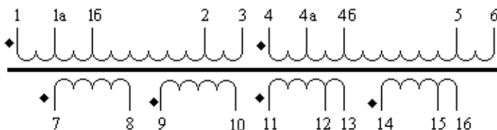
Рисунок 6.3.3 – Схема електрична принципова низьковольтного трансформатора ТН33-127/220-50
