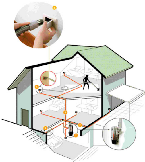
Рис. 7.3. Схема влаштування мереж центрального пылесоса
