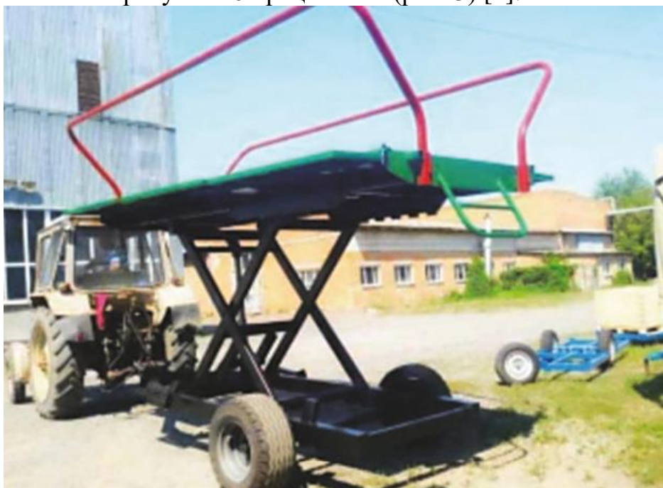
Рисунок 3. Платформа підйомна причіпна для садівництва виробництва ТДВ «Брацлав» (Україна)
