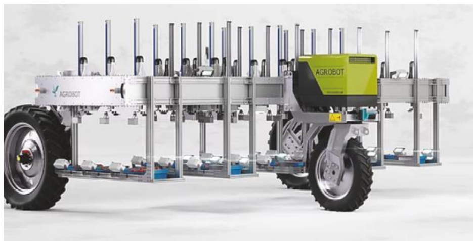
Рисунок 5. Роботозбиральний комбайн для м'якого збирання полуниці
