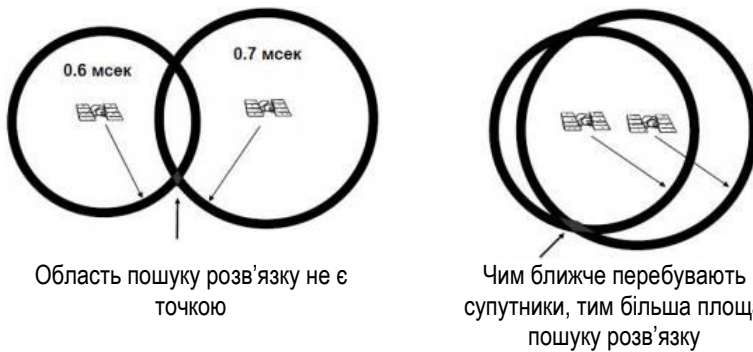
Рис. 23. Розташування супутників впливає на якість оберненої засічки
