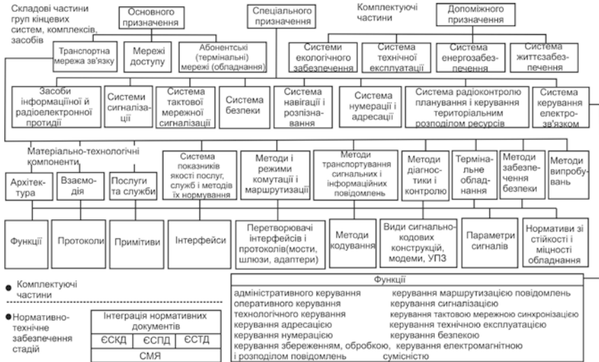
Рис. 5.2. Класифікаційна структура об'єктів стандартизації: ЄСКД – Єдина система конструкторської документації; ЄСПД – Єдина система програмної документації; ЄСТД – Єдина система технологічної документації; СМЯ – Система менеджменту якості (ISO 9000-2000)
