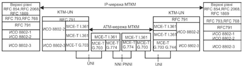
Рис. 6.10. Надання мультисервісних послуг у МТКМ із застосуванням КТМ після модернізації
