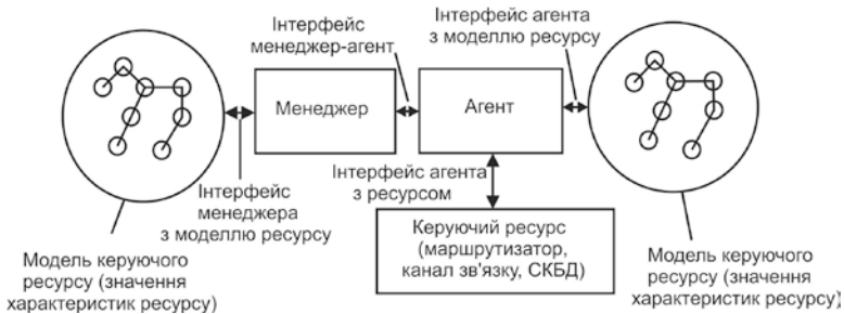
Рис. 3.25. Приклад взаємодії керуючих і керованих елементів в АСК ТКМ
