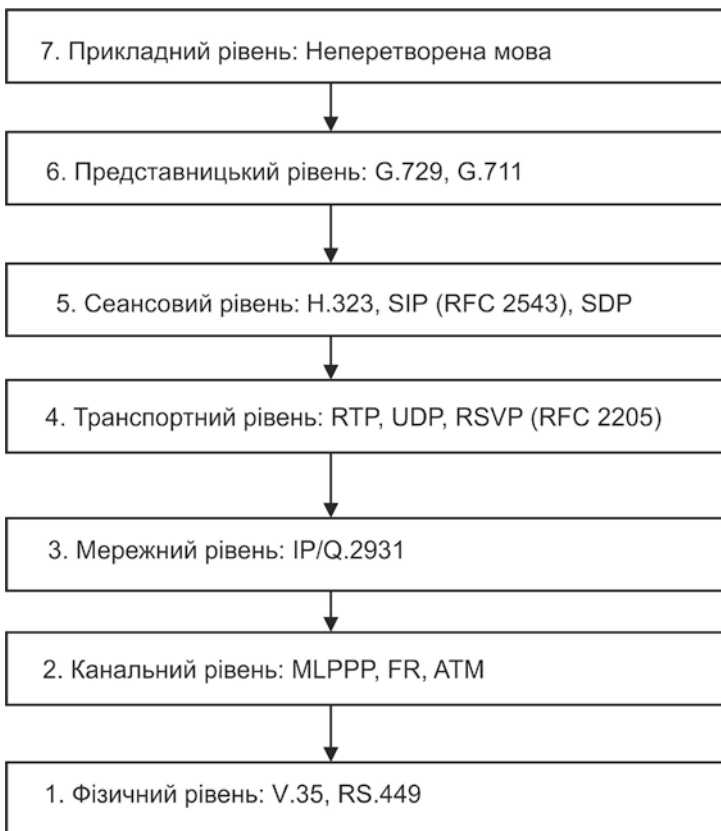
Рис. 6.5. Стек протоколів пакетного передавання мови для МТКМ
