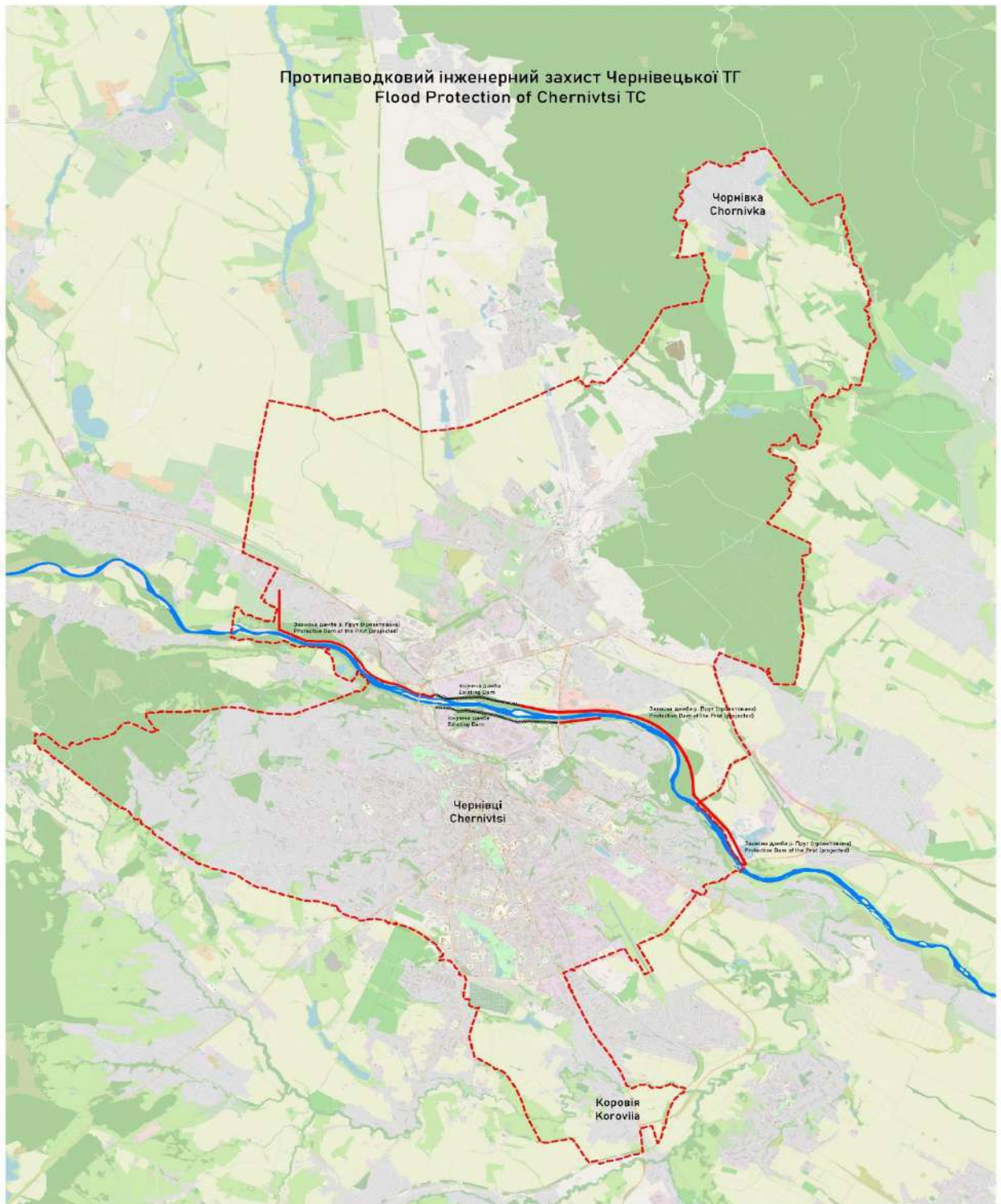
Рис. 4.5. Система захисних дамб та інших інженерних споруд повздож річки Прут (Державний комітет України по водному господарству. Державний регіональний проектно-розвідувальний інститут «ЛьВІВДІПРОВОДГОСП». Противаводковий інженерний захист м. Чернівці. Техніко економічний розрахунок (ТЕР). Львів, 2008)
