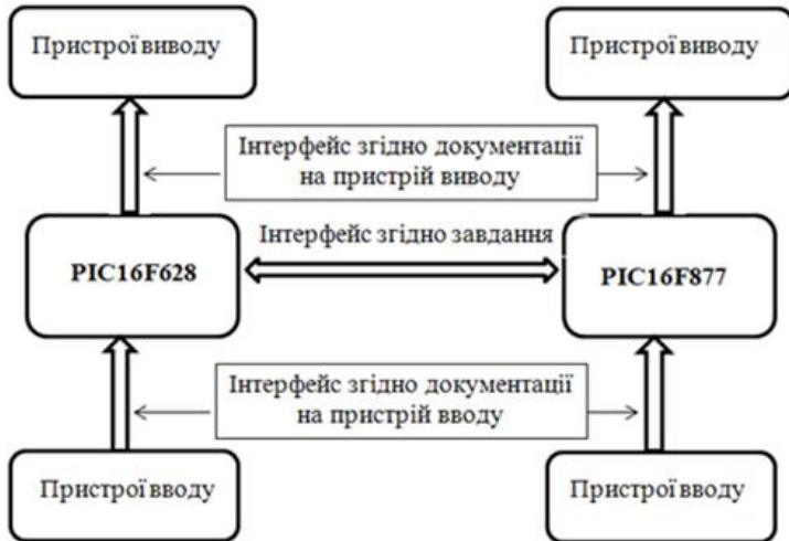
Рис. 1. Узагальнена блок схема системи на базі мікроконтролерів PIC16F628 та PIC16F877.
