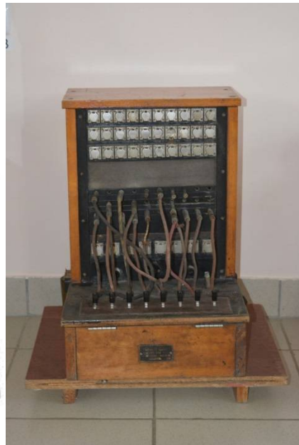
Рис. 5 Комутаторної дошка системи Гіллеланда (а), прототип Свердловського заводу (б)
