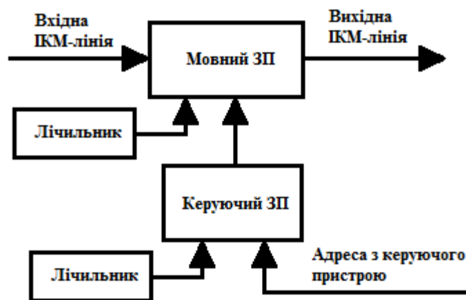
Рис. 8. Загальна схема реалізації T -каскаду
