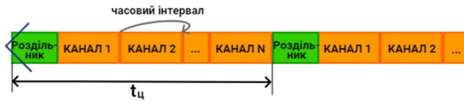
Рис. 12. Структура циклу асинхронного мультиплексування ( t_{\text{ц}} - тривалість циклу)
