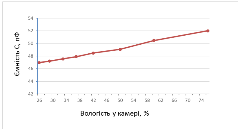
Рис. 4. Залежність ємності конденсатора від вологості у камері
