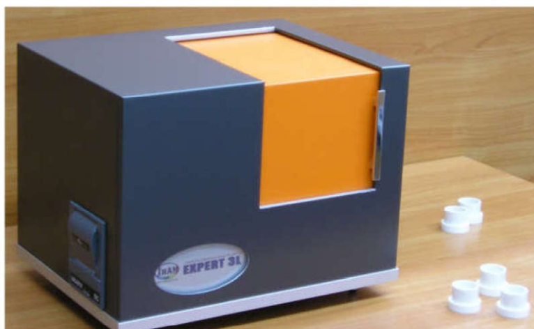
Рис. 2.9. Рентгенофлуоресцентний аналізатор EXPERT 3L
