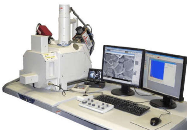
Рис. 2.10. Фото SEM установки з рентгенівським мікрозондом EDX.
