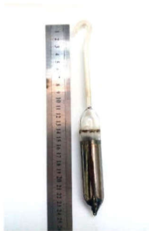
Рис. 2. 4. Фото готової для росту кристала запаяної ампули з полікристалічним \text{Cd}_{1-x-y}\text{Mn}_x\text{Zn}_y\text{Te} ( x=0.05-0.30 , y=0.05-0.15 )
