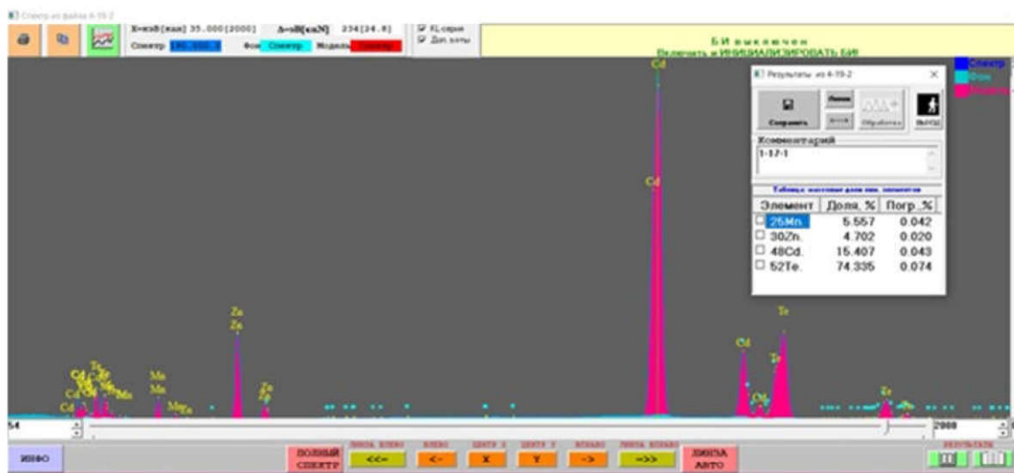
Рис. 4.7. Типовий XRF - спектр зразка \text{Cd}_{0.80}\text{Mn}_{0.10}\text{Zn}_{0.10}\text{Te} ( g = 0,4 )
