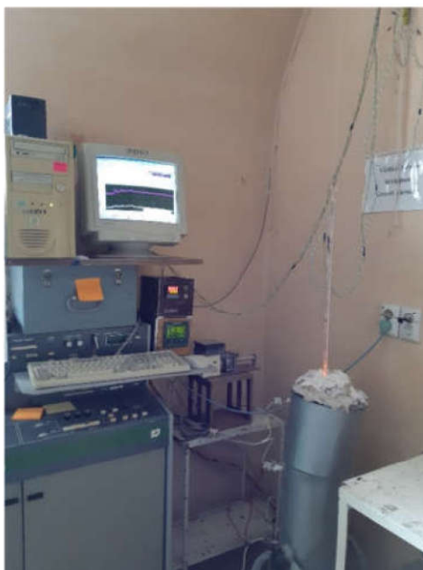
Рис. 2.5. Фото установки для росту кристалів (піч Бріджмена).
