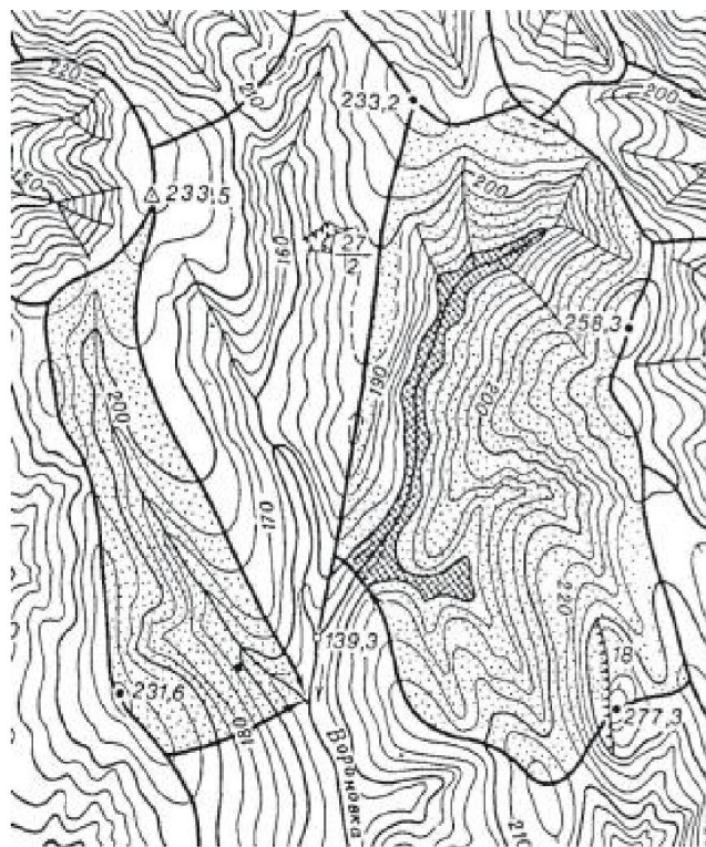
Рис. 23. Схема визначення водозбірної площі та площі затоплення за топографічною картою[24]
