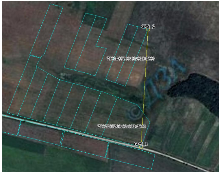
Рис. 30. Схема розташування та визначення вихідних координат засобами GPS
