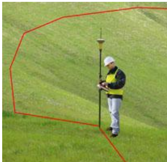
Рис. 45. Загальна схема перенесення проектних відміток межі прибережної захисної смуги в режимі RTK
