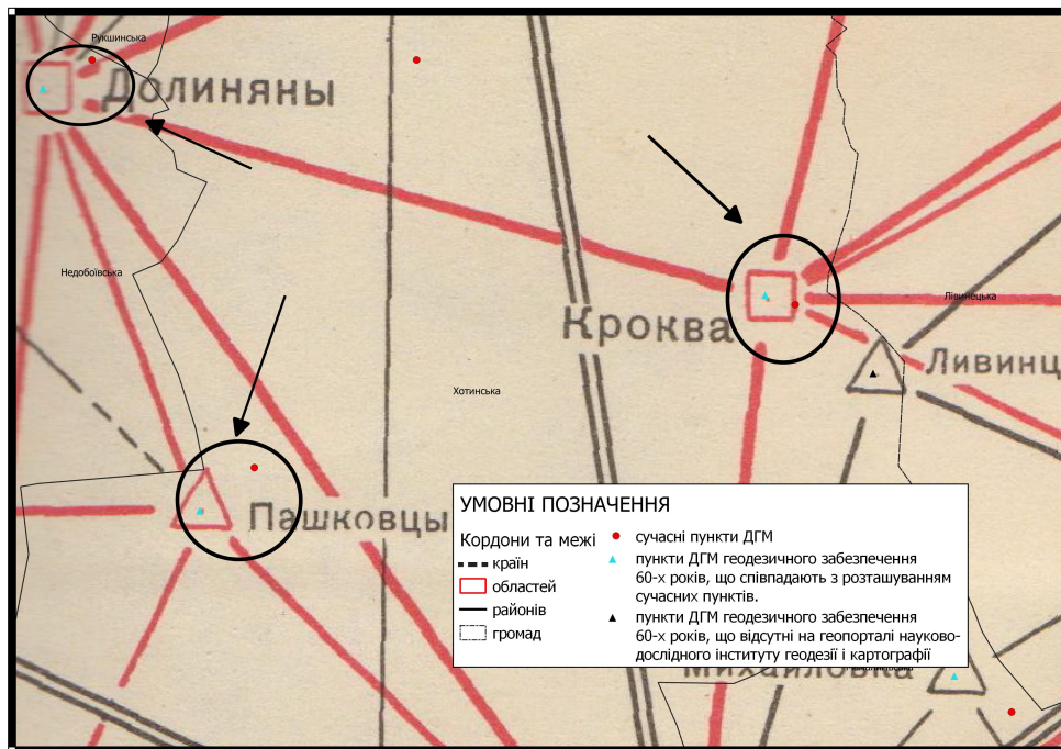
Рис. 3.33 Неспівпадіння просторових характеристик пунктів ДГМ сучасних та існуючих в 60-ті роки
