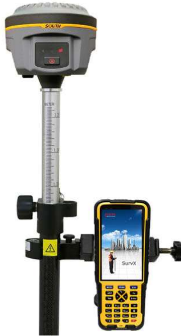
Рис. 2.5. Вигляд South Galaxy G1 з польовим контролером H3 Plus
