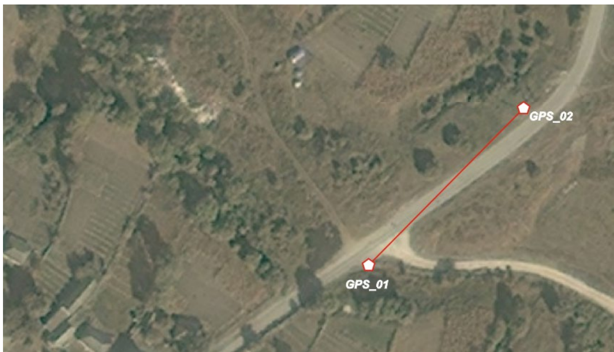
Рис. 3.10. Створення опорної геодезичної мережі GNSS-методом
