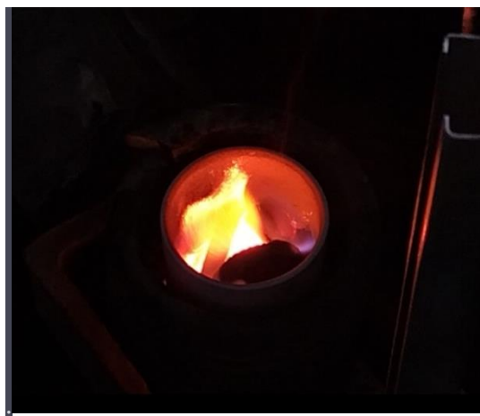
Рисунок 4 - Вуглетермічне відновлення брикетів в умовах індукційного нагріву.
