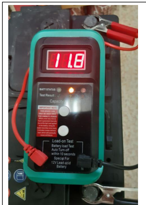
Фиг.3. Измерване на напрежение с товар
