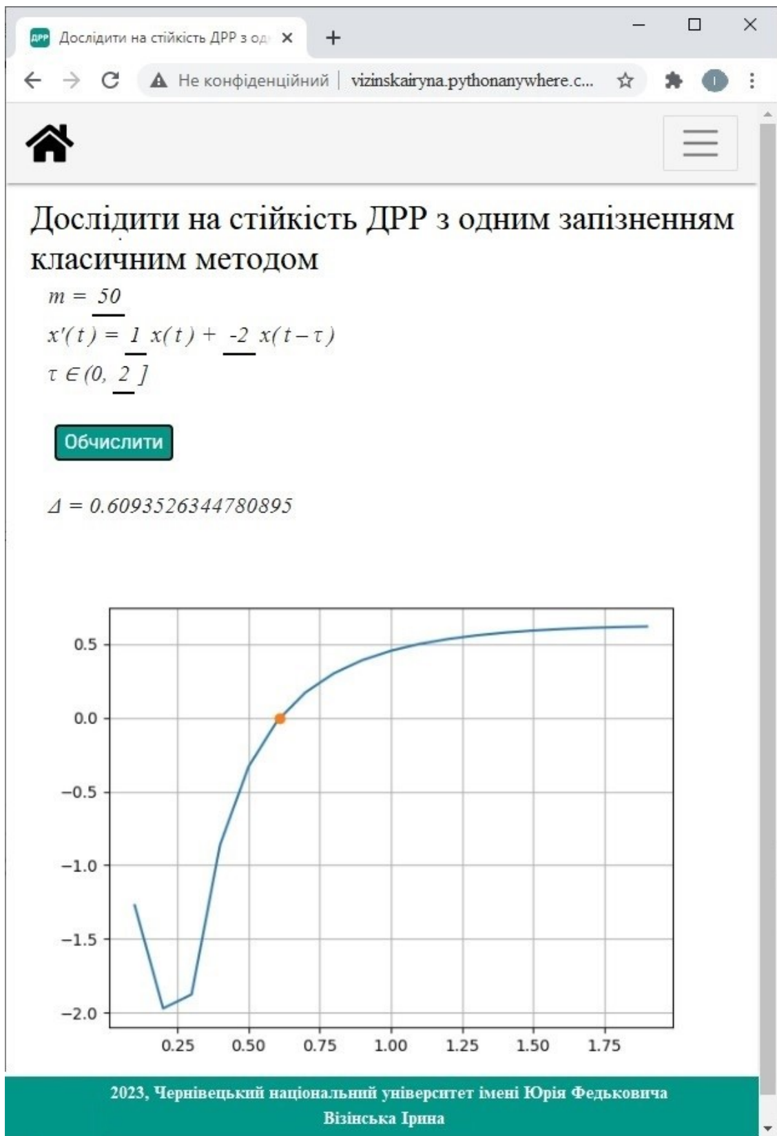
Рис. 4.4 Дослідження на стійкість рівняння з одним запізненням за класичною схемою
