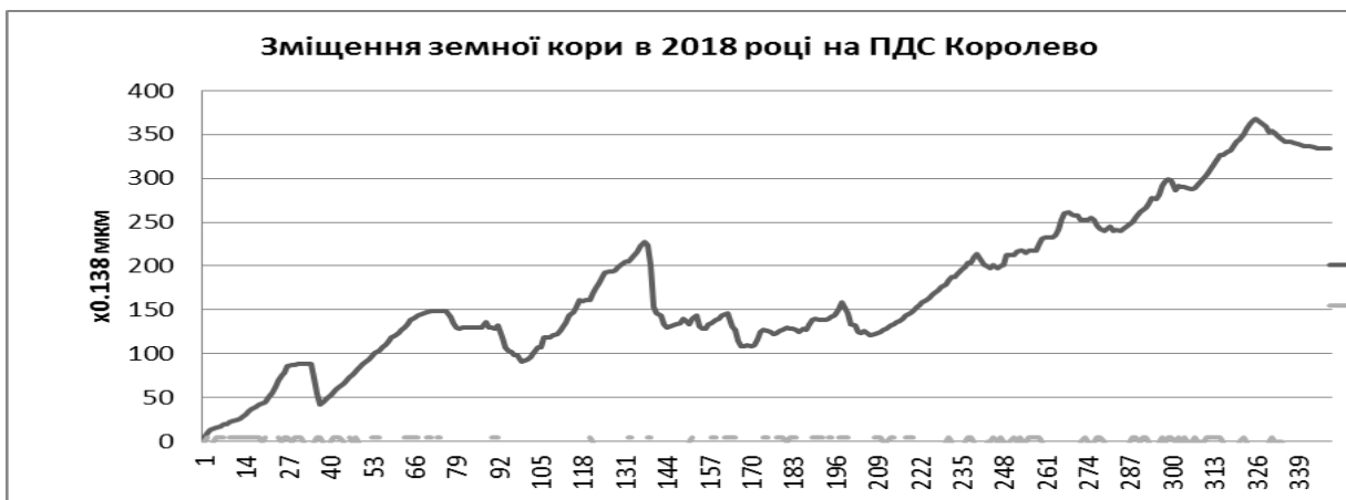
Рисунок 3.1. Геодинамічний стан Закарпатського внутрішнього прогину в 2018 році за результатами деформетричних спостережень на ПДС <<Королеве>>.
