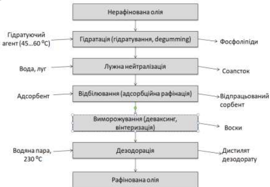
Рис. 1.10. Технологічна схема рафінації олії
