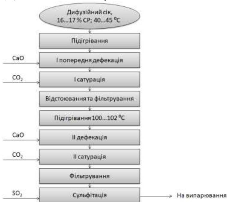
Рис. 4.4. Технологічна схема очищення дифузійного соку
