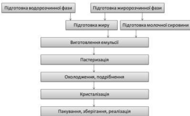
Рис. 2.2. Технологічна схема виробництва маргарину
