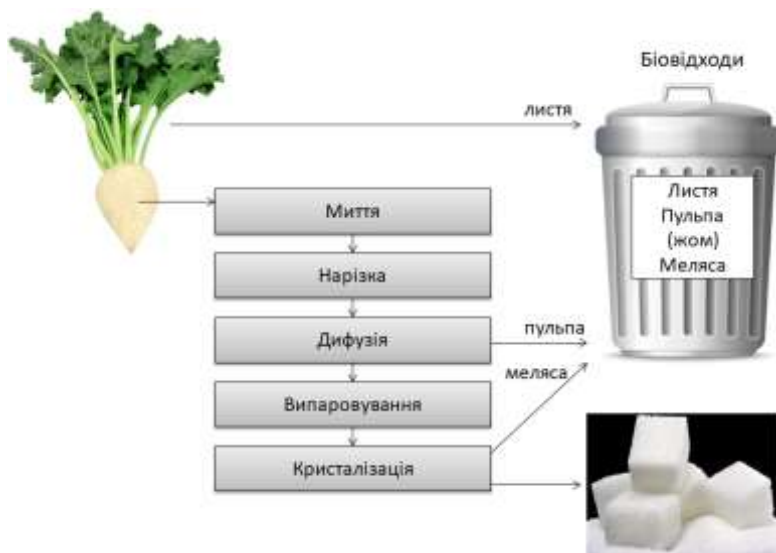
Рис. 4.2. Основні стадії переробки цукрових буряків
