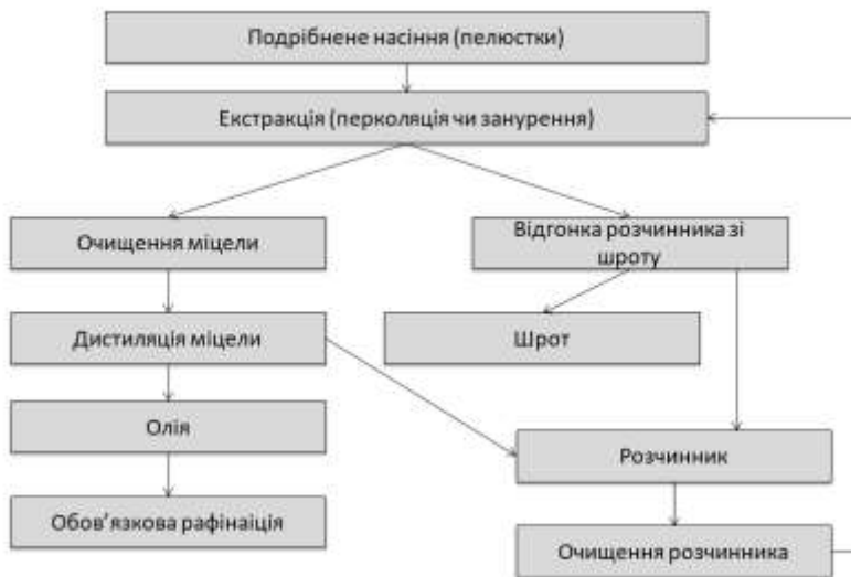
Рис. 1.8. Екстракційне вилучення олії з м'язги або ядра
