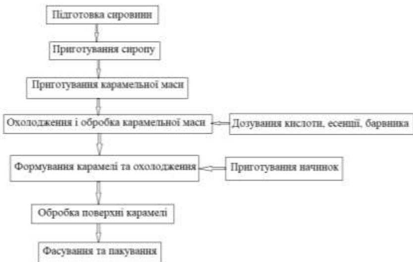
Рис. 5.2. Технологічна схема виробництва карамелі льодяникової
