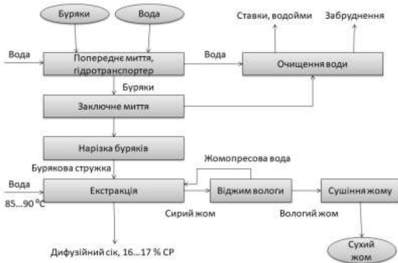
Рис. 4.3. Технологічна схема отримання дифузійного соку
