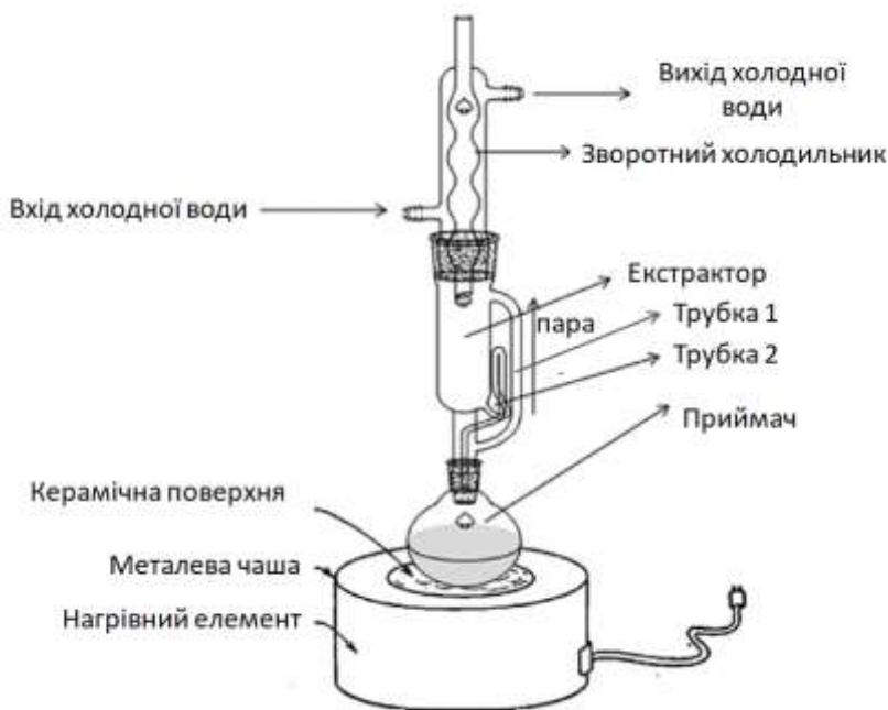
Рис. 4.2. Будова апарату Сокслета.
