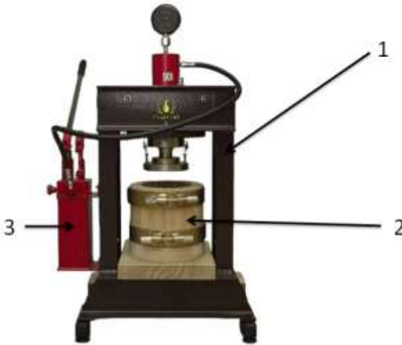
Рис. 4.1. Гідравлічний прес для вичавлювання олії: 1 – металевий корпус; 2 – дерев’яний кошик; 3 – домкрат
