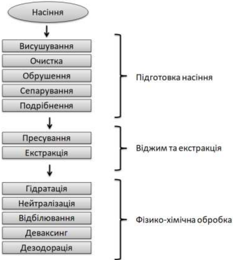
Рис. 1.5. Загальна технологічна схема виробництва соняшникової олії
