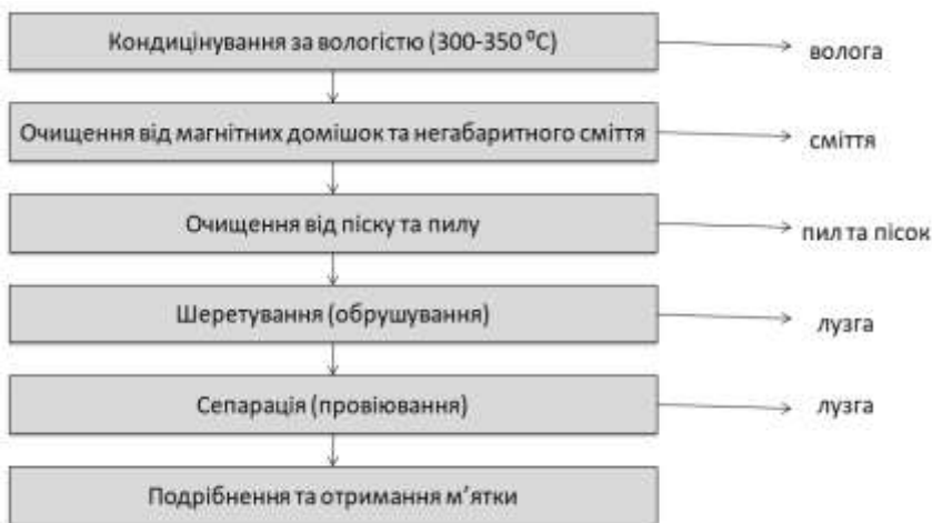
Рис. 1.6. Технологічні етапи отримання м'ятки з олійної сировини
