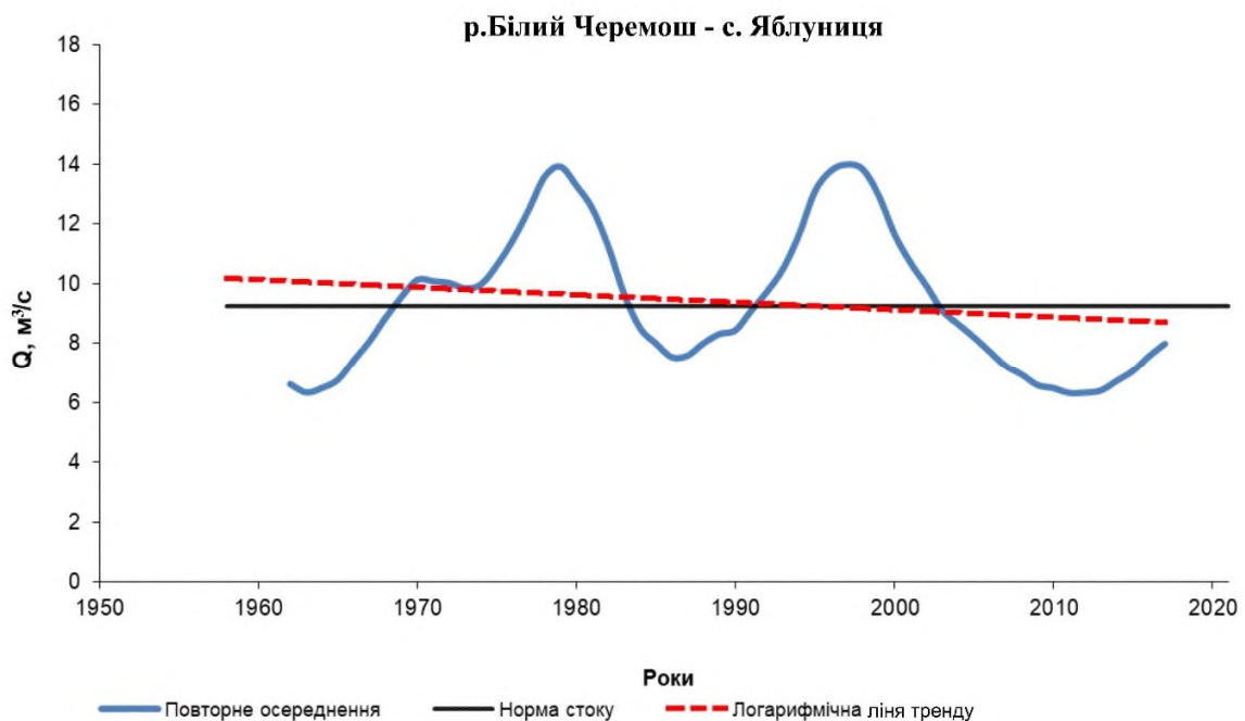
Рис. 2. Графік ходу середньорічних витрат води (повторне плинуче осереднення) на р. Білий Черемош в с. Яблуниця за 1962–2017 рр. з логарифмічною лінією тренду.
