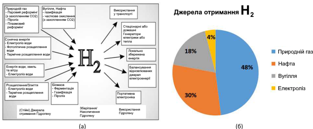
Рис. 1. Методи виробництва водню та різні кінцеві користувачі (а), відсоток джерел виробництва водню (б)
