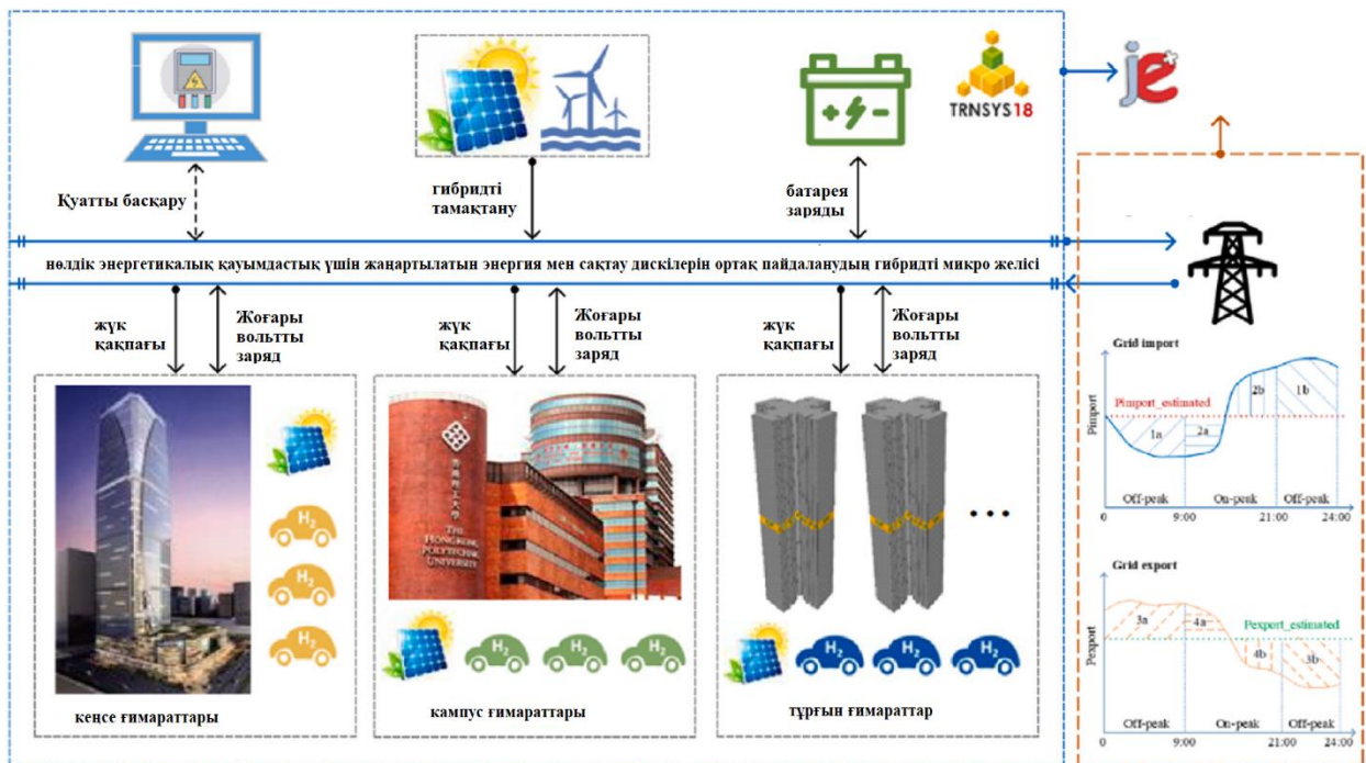
Сурет 5. Нөлдік энергетикалық қауымдастық үшін пайдаланылатын гибриді жаңартылатын энергия және сақтау жүйесінің құрылымы.
