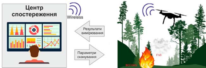
Рис. 11. Функціональна схема системи автоматизованого моніторингу викидів тепла і виявлення потенційно небезпечних пожеж
