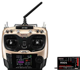
Рис. 7. Пульти управління 10к Radiolink AT9s та приймач R9D SBUS
