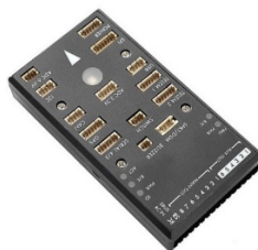
Рис. 6. Контролер польоту Pixhawk 2.4.5
