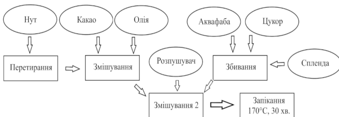
Рис. 1. Принципова технологічна схема виробництва кексу низькокалорійного «Шоколадний»
