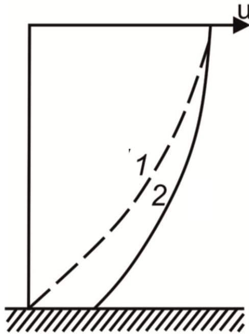
Рис. 7.4. Епюри розподілу швидкостей течії по глибині : 1 – ламінарний рух; 2 – турбулентний рух
