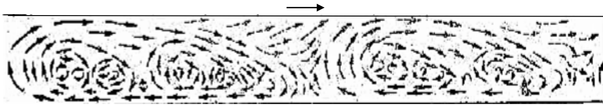
Рис. 22.1. Схема кінематичної структури руслового турбулентного потоку за А. Б. Клавером (1982, с. 172)
