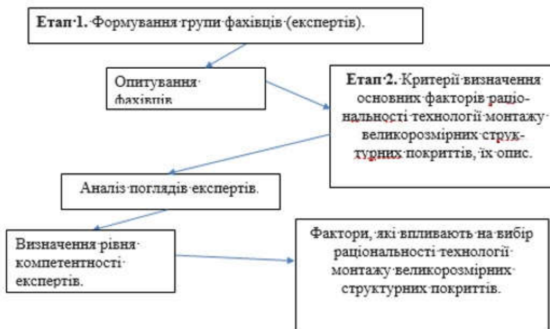
Рис. 1. Загальна схема методики дослідження основних факторів визначення раціональності методів монтажу великорозмірних структурних покриттів. Визначення ступеня компетентності експерта проводилося за допомогою системи коефіцієнтів вагомості: високий рівень самооцінки експерта при прирівнюється 1, середній – 0,8, найнижчий – 0,5.
