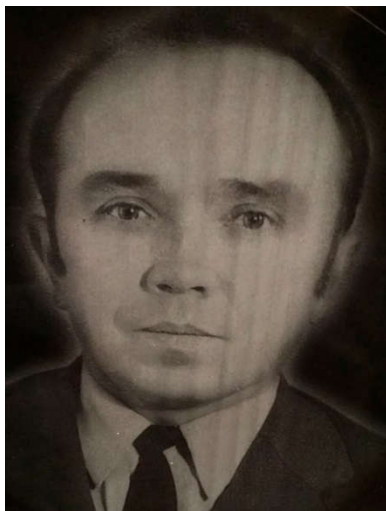
Рис.3 Зображення при невірному налаштуванні оптичної та механічної систем лазерного гравера
