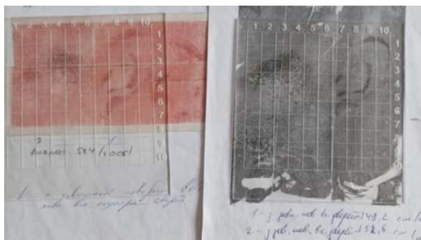
Зображення 76: Одночасне накладання пластин з координатними сітками для визначення відповідності положення елементів в порівнювальних слідах вушних раковин
