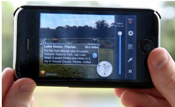
Рис. 3.4.11 — Приклад роботи додатку Wikitude World Browser на iPhone 3GS, що використовує GPS і цифровий компас для відображення доповненої реальності (AR).
