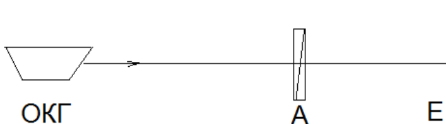
Рис.1. Схема для дослідження стану поляризації випромінювання ОКГ А – аналізатор, Е – екран.
