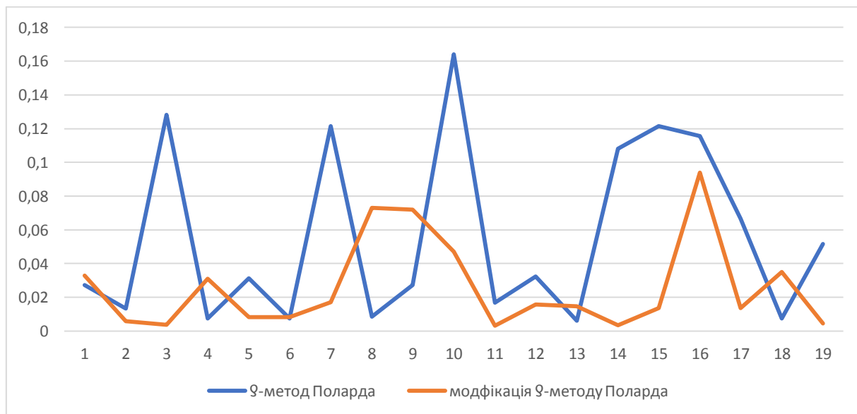
Рис. 3. Графік часу роботи q-методу Поларда та запропонованої модифікації методу для p довжиною 2 байти
